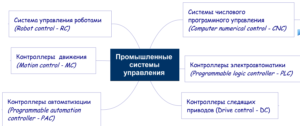
Рис. 1. Виды систем управления технологическим оборудованием
