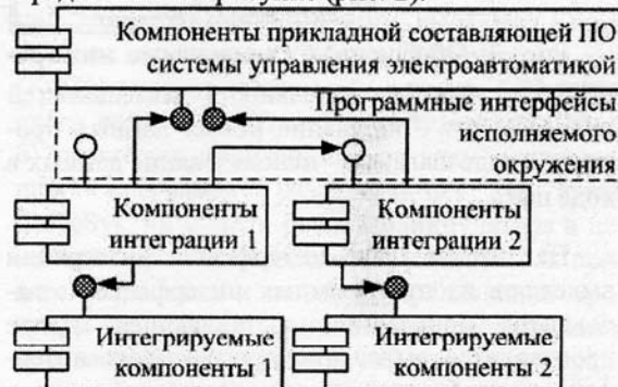
Рис. 2. Пример использования программных интерфейсов в компонентах интеграции
