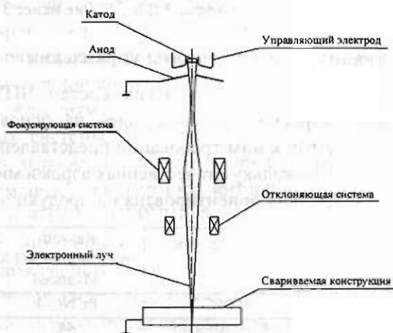
Рис. 1. Принцип формирования электронного луча
