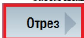
Заполняем таблицу в соответствии с заданными условиями: выбираем инструмент из заполненного ранее магазина, вводим рекомендованный производителем режущего инструмента режим резания (скорость и подача в начале отрезания, пониженные скорость и подача в конце отрезания), вводим геометрические параметры отрезки (начальная точка, конечная точка, тип и величина притупления).
