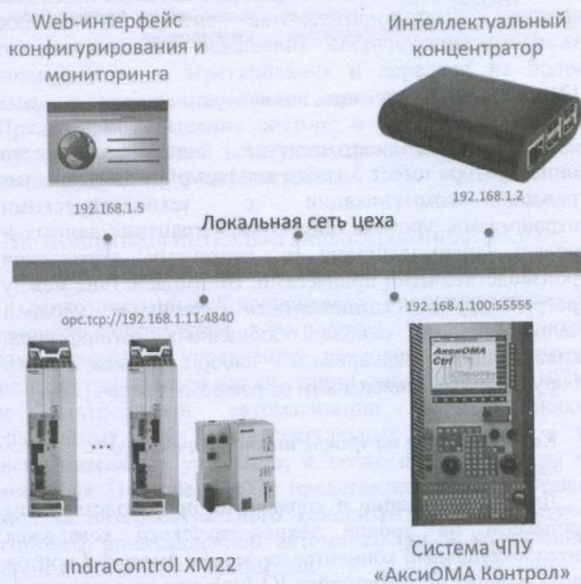
Рис. 2. Структура тестового стенда сбора данных
