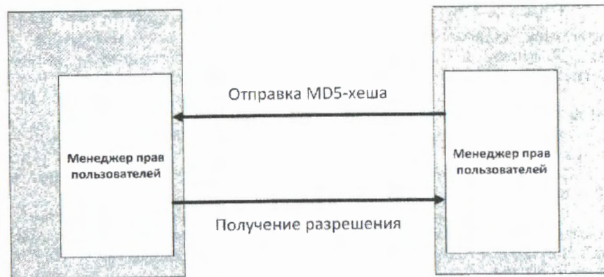
Рисунок 1 – Поток данных между терминалом и ядром СЧПУ
