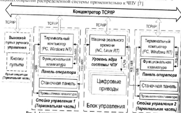
Рис. 1. Архитектура многотерминального испытательного стенда
