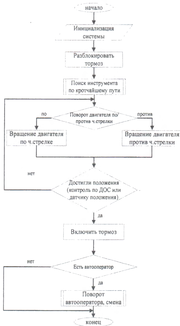
рис. 2 Алгоритм смены инструмента для револьверных головок
