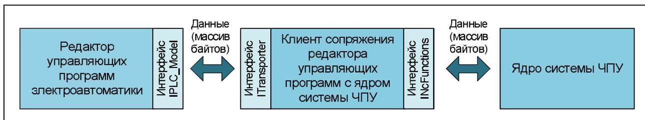
Рис. 5. Схема взаимодействия редактора управляющих программ с ядром системы ЧПУ
