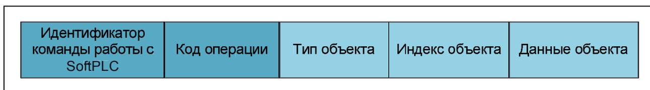
Рис. 6. Обобщенная структура пакета данных при передаче в ядро функционального блока управляющей программы
