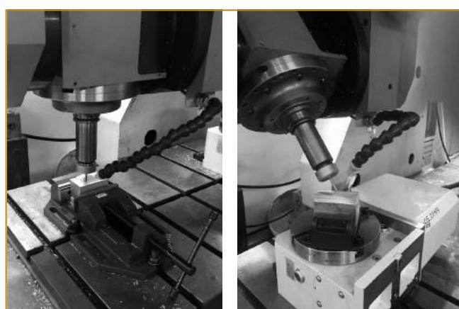
Рис. 5. Обработка деталей в трехосевом (а) и пятиосевом (б) режимах
