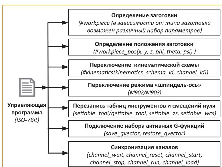
Рис. 2. Структура УП на языке высокого уровня и группы функций, необходимые для смены кинематической схемы
