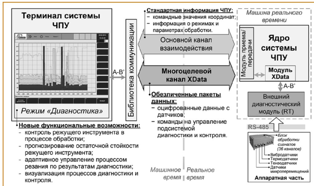
Рис. 4. Структура подсистемы диагностики режущего инструмента, интегрированной в систему ЧПУ «АксиОМА Контрол»
