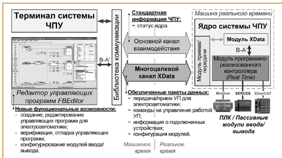
Рис. 5. Структура инструментария разработки и отладки программ для SoftPLC, интегрированного в систему ЧПУ «АксиОМА Контрол»
