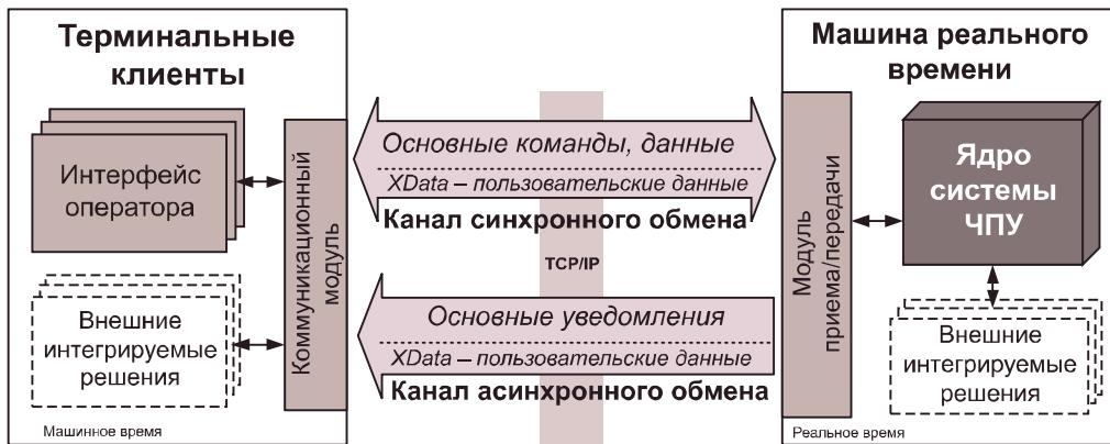
Рис. 1. Структура взаимодействия основных компонентов системы ЧПУ
