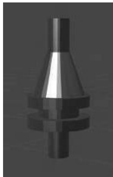
Рис. 7. Пространственный вид модели инструмента, совмещенного с цанговым патроном
