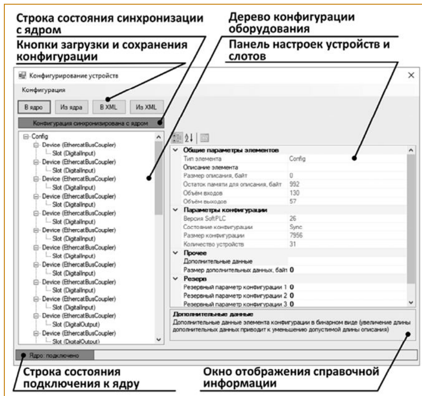
Рис. 4. Конфигурирование устройств электроавтоматики
