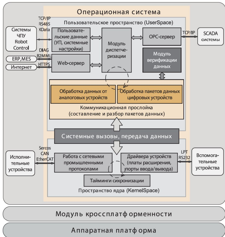
Рис. 2. Архитектурная модель системы логического управления
