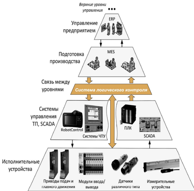
Рис. 1. Структура цифрового машиностроительного производства с выделением системы логического управления
